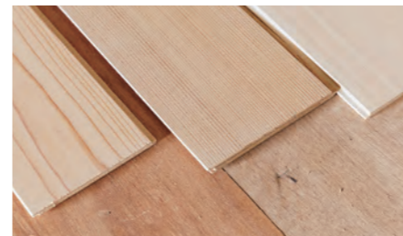
同社では木材を0.2ミリという薄さにスライスする設備を備えており、木の質感を感じられる天井板や床板、壁用部材を製作。
