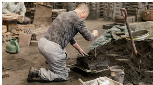
熟練の職人が行っている、金属を流し込むための砂型を作る作業。
