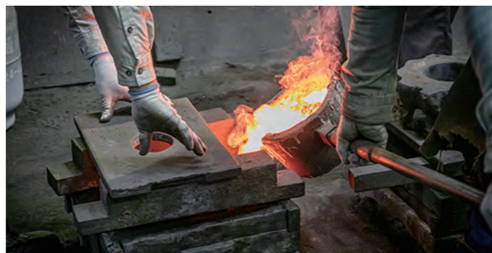
手づくりした型に溶かした金属を流し込む作業は繊細な作業だ。
