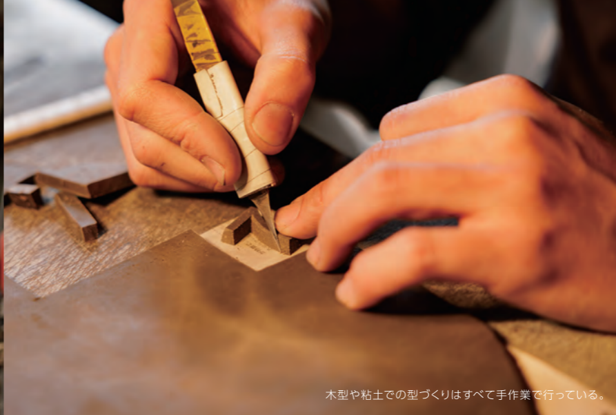
熟練の職人が行っている、金属を流し込むための砂型を作る作業。
