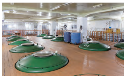
伝統的な酒造りを大切にする、秋田ならではの「低温長期熟成」を実現する、もろみを発酵させるタンクが並び。
