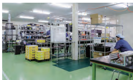
柔軟に製造ラインを組むことができるセル方式を採用された工場内。
