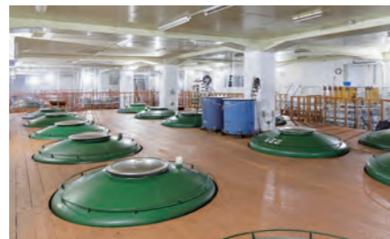
伝統的な酒造りを大切にする、秋田ならではの「低温長期熟成」を実現する、もろみを発酵させるタンクが並ぶ。
