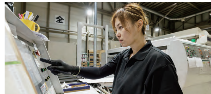
カラー印刷、筋入れを行う機械を操作する。
