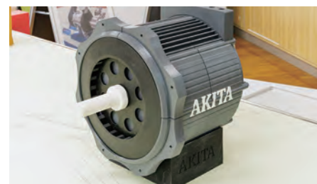
MW級航空機推進用モーターの実寸大模型。
