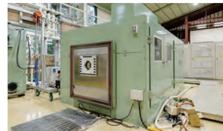
出力400kW、最高試験速度20,000rpmまで対応可能な国内最大級のモーターベンチ。
