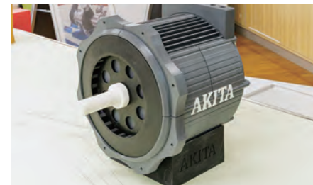
MW級航空機推進用モーターの実寸大模型。
