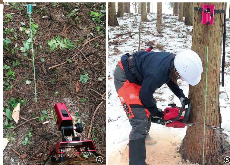
④レーザーを反射板に照射し、伐倒目標位置を定める。 ⑤レーザーをガイドに正確な伐倒方向を確認しながら「受け口」を作ることが可能に。 ※レーザーを見やすくするため、写真を一部加工しています。
