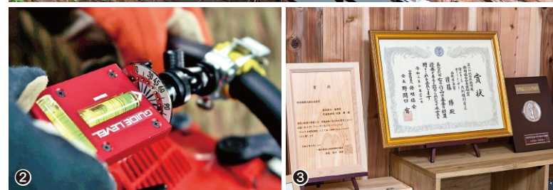
①コンパクトで持ち運びがしやすく、新人からベテランまで簡単に使用できる。 ②角度板で15度ピッチ毎に設定が可能。 ③社長室には、賞状や特許証が並ぶ。
